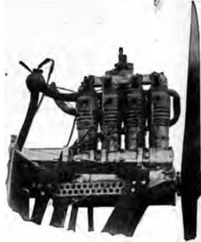
Fig. 21. Panhard Aviation Motor
